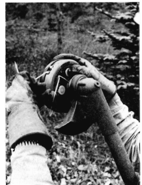
Fig. 5. Snørehoved til montering på kratrydder. De 10–15 cm lange snører slår græs- og urteopvækst.
