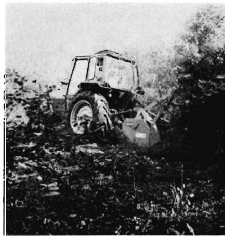
Fig 4. NICOLAS Grenknuser, velegnet til svære tyndingsopgaver.
