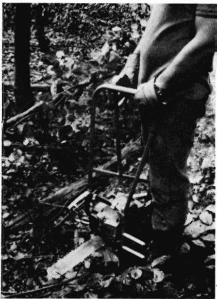
Fig. 2. Det finske fældningshåndtag på en Husqvarna sav.
