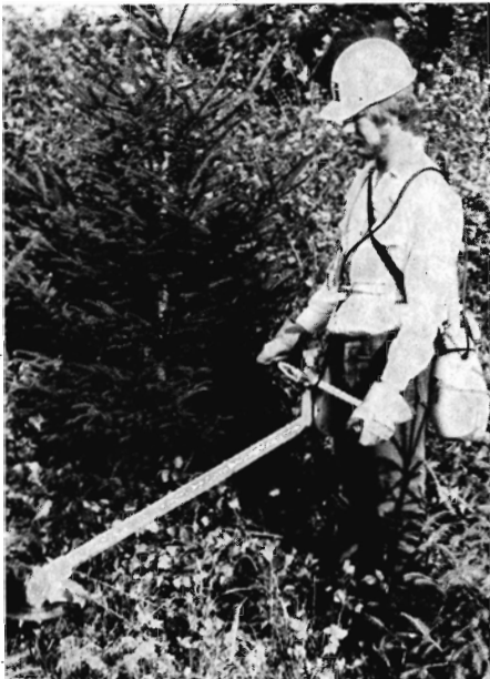
Fig. 3. Husqvarna 165 R kratrydningssav monteret med sprøjteudstyr.
