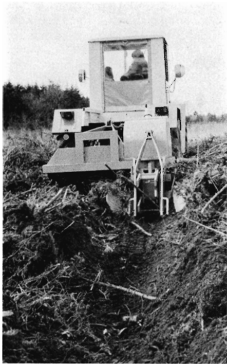
Fig 3. GREMO Kvasknuser med bevægelig rotor og rømningsplov.
