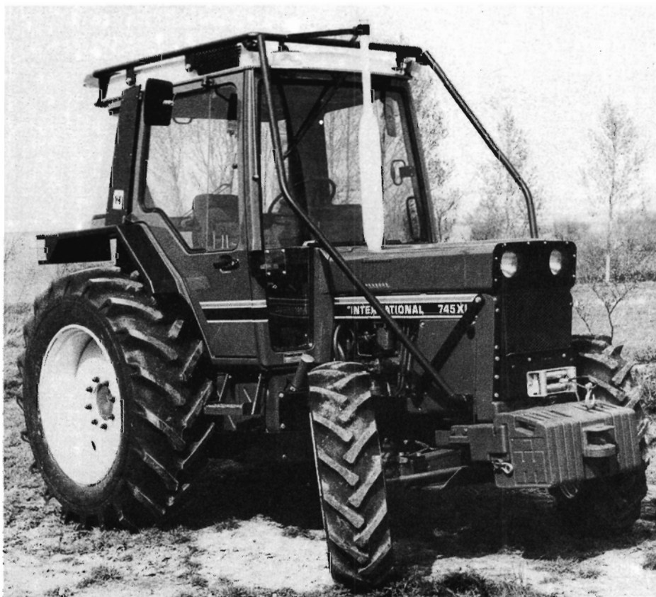
Fig. 4. IH 745 XL er af IH specielt hjemtaget og ombygget til skovbruget. Bemærk det indbyggede bjærgningsspil i fronten.
