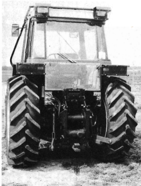
Fig. 5. IH 745 XL med udbygning af førerhus for bagudvendt førerplads (version 2 og 3). Bemærk lynkoblingernes hensigtsmæssige placering.
