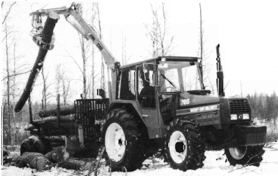
Fig. 10. Den nye Volvo BM Valmet traktor, her model 705, er fra fabrikken konstrueret med henblik på skovkørsel. Som standard har traktoren vendbar førersæde.
