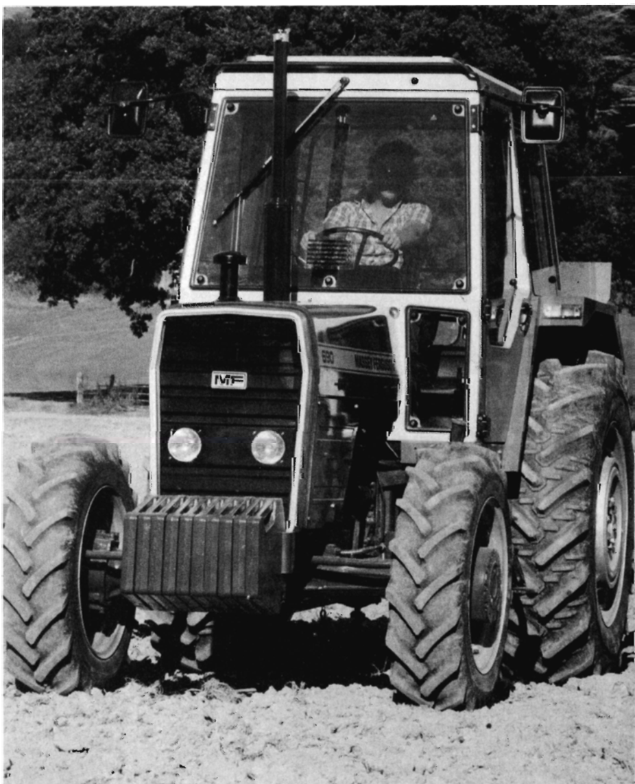
Fig. 8. MF 690 med 4-hjulsdrev. Traktoren har bl.a. fået nyt førerhus og ny design.
