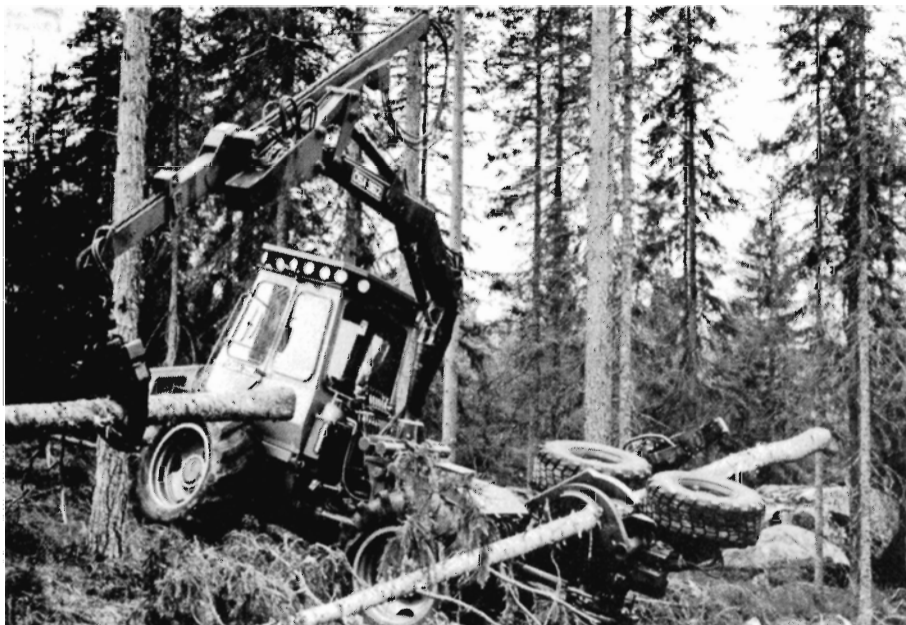
OSA's lille tyndingsprocessor med longkran og gummihjul som maderuller på kvistningsenheden.
