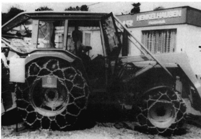
Fig. 1. Firhjulsdrevet landbrugstraktor med typisk skovudrustning.
