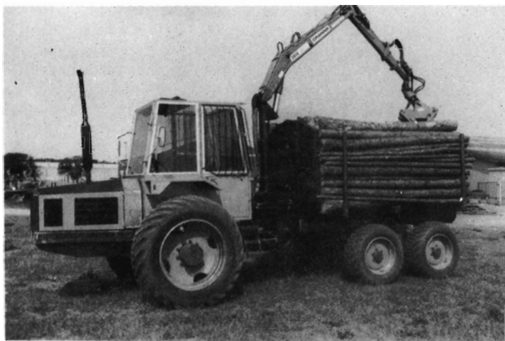
Fig. 3. Gremo TT8H måler 2,10 m i bredden og laster 8000 kg.
