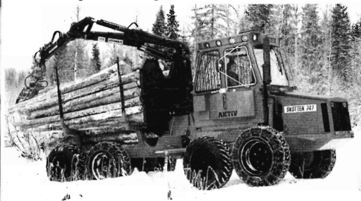
Fig. 2. Aktiv Skotten med dobbelt boggi er 2.20 m bred og laster 7000 kg.
