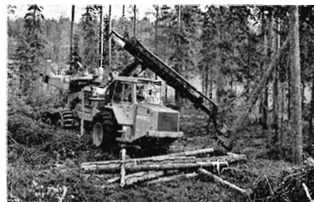
Fig. 8. Volvo BM 900 fælde/oparbejder, der med eenmandsbetjening klarer fældning og oparbejdning på renafrifter.
