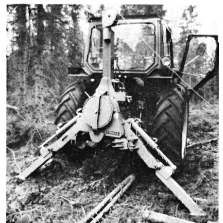
Fig. 4. Et traktormonteret radiomanøvreret spil fra Trima med støtteben og højt trækpunkt.
