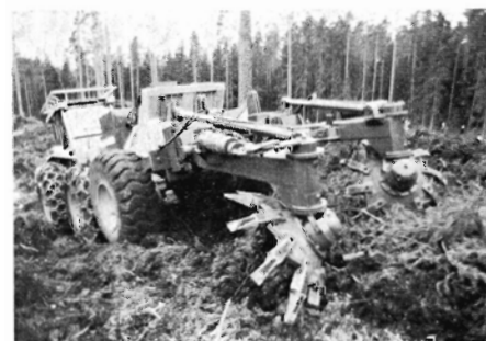
Fig. 9. Markberedning med stor specialmaskine anvendes idag meget i Sverige.
