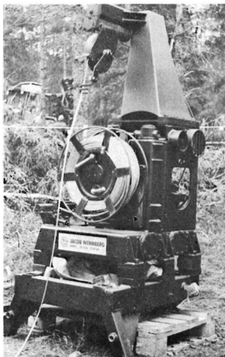
Fig. 5. Jaco hydraulisk spil med separat opbevaringstromle, der let kan byttes ud.
