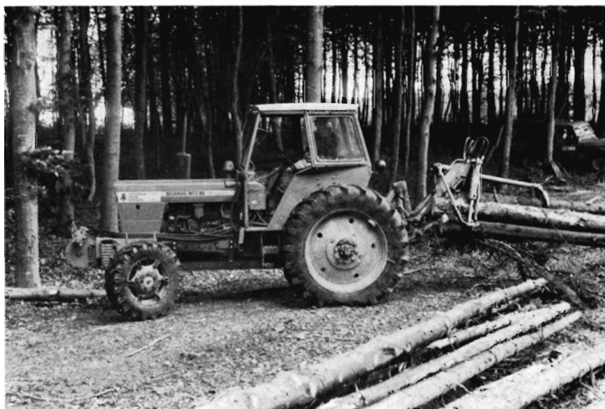
KUXMANN saks og frontmonteret KUXMANN hydraulisk spil.
