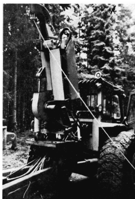
Fig. 6. Hydraulisk spil – Tiltvinde – til montering på brugt specialtraktor. Kan tippes i længderetning og har meget højt træpunkt.
