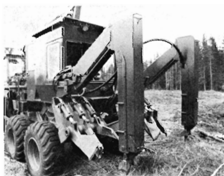
Fig. 10. Jordbearbejdnings-, plante- og styreenheder på Ösa's forsøgsplantemaskine.
