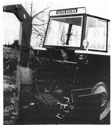
Fig. 3. TP flishugger type TP 950 med hydraulisk madeværk.
