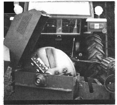
Fig. 4. TP flishugger er let tilgængelig for service.
