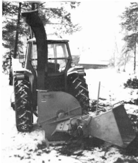
Fig. 1. Junkkari HJ 10 flishugger med to hydrauliske madevalser.
