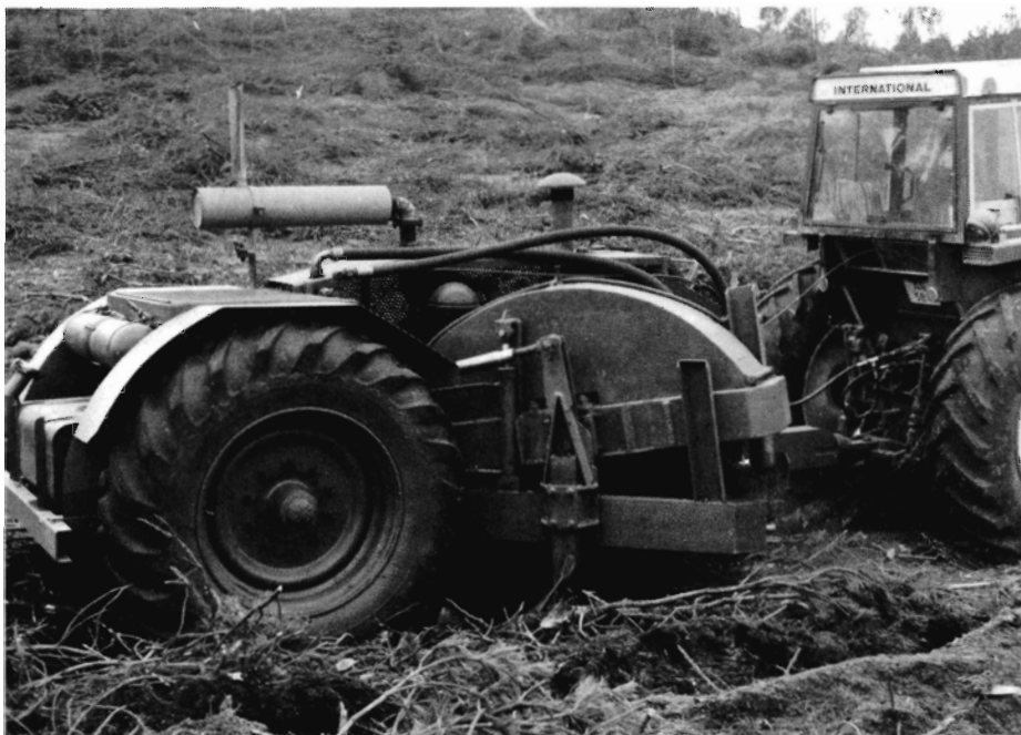
Fig. 3. SFF-kvasknuseren er blevet bugseret og med separat motor som kraftkilde. (SI-foto).
