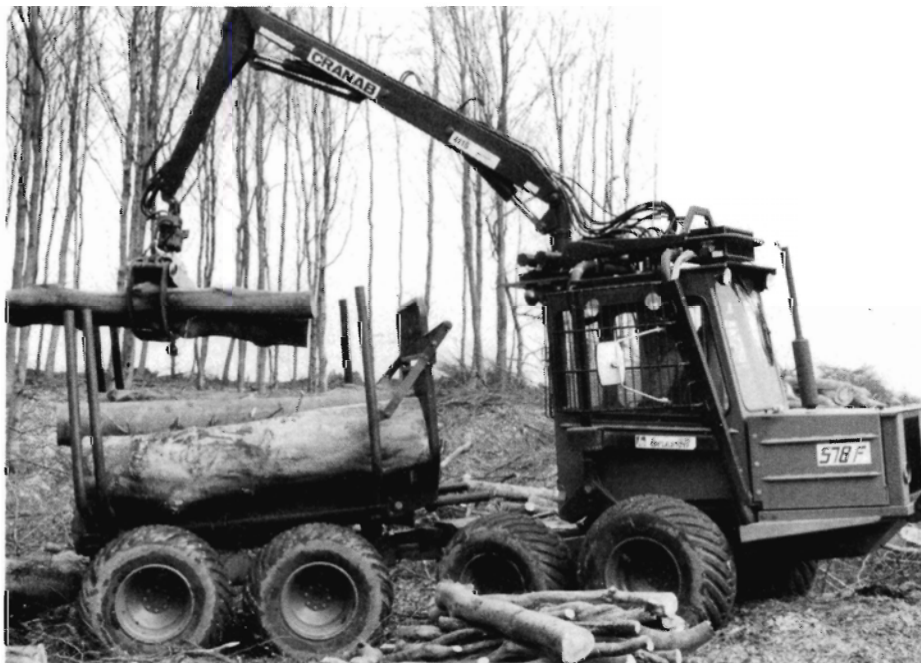
Fig. 1. Bruunett Mini'en er en lille udkørselstraktor med en lasteevne på 7 ton. Den dobbelte boggiemontering og den centrerede midje gør den meget terrænfremkommelig. (SI-foto).
