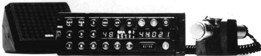
Fig. 5. Mobilradioen betjenes udelukkende med trykknapper, bortset fra volumenkontrollen, som sidder på mikrofonen.
