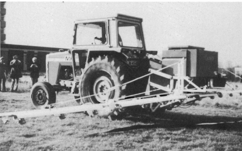
Fig. 10. Horstine Farmery's „Micro-drop“ CDA-sprøjte. Skiverne drives ved kabel- og remtræk. Spredébommen er hydraulisk manøvreret.
