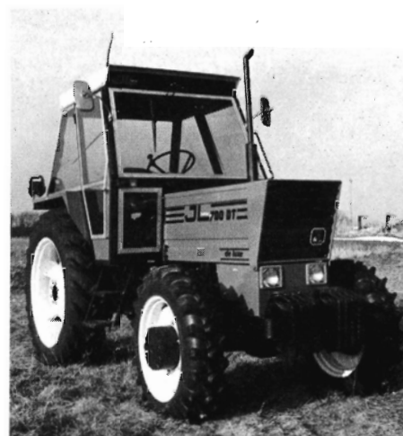
JL-model 700 DT de luxe, hvilket vil sige en dansk traktor på ca. 70 Hk DIN med et solidt forhjulstræk og en velindrettet førerkabine med et støjniveau på max. 80 dB(A).
