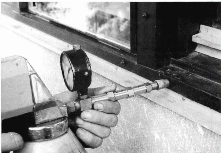
Fig. 2. Der presses væske ind i træet - under tryk.
