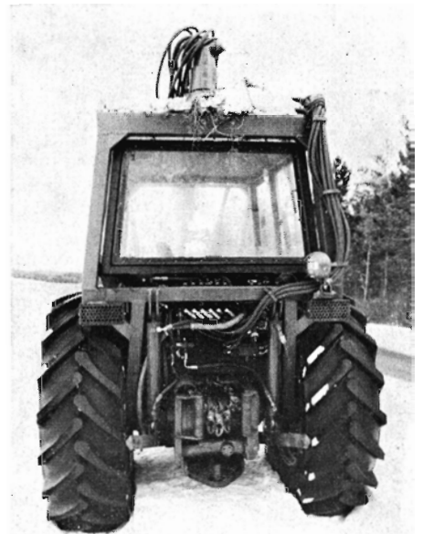
Fig. 2. Nyt Indslev spil, udvendig lift og godt udsyn for føreren.
