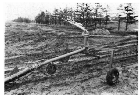
Fig. 3. Spredner monteret på vogn til brug ved indtræksmaskiner.
