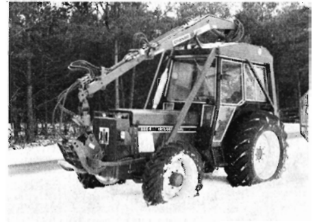
Fig. 1. IH 844 (4x4) med nykonstrueret kranmonteringsramme.
