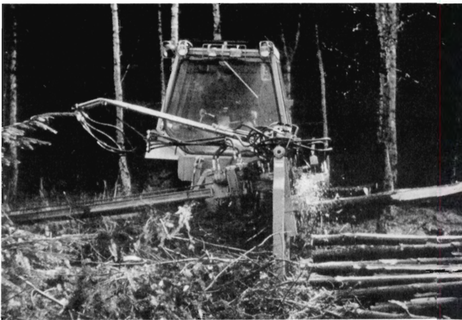
Fig. 2. Afkvistning, afkortning og bunkelægning kan let mekaniseres med f. eks. STRIPPER afkvistningsmaskine.
