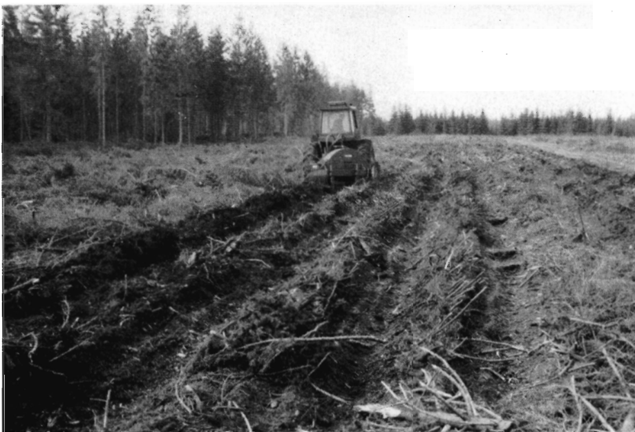
Fig. 4. SFF-knuseren. Redskab og arbejdsresultat. Agerskov plantage, forsøg nr. 1244.
