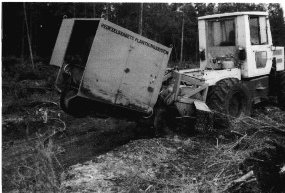
Fig. 5. Hedeselskabets plantningssystem. T.V.: Knuser + plov + plantekabine. T.H.: Arbejdsresultat efter knuser + plov (incl. grubber) alene. Agerskov plantage, forsøg nr. 1244.
