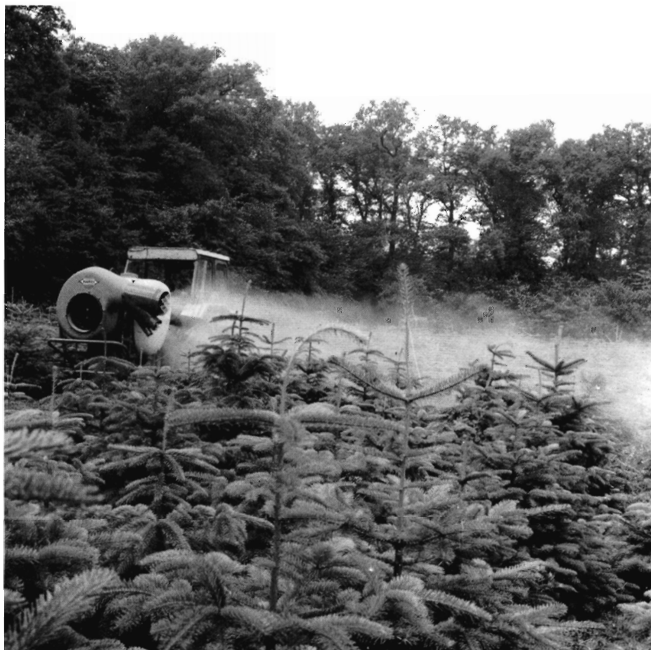
Fig. 1. Hardi tågesprøjte med 3-tudet blæserhoved ved sprøjtning af ædelgranlus i nordmannsgran.
