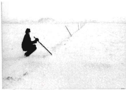
Fig. 4. Hegnet er elastisk og kan tvinges helt mod jorden uden at knække. (SI-foto).
