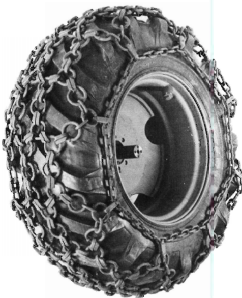
Fig. 6 Ny type hjulkæder med specielle led, som ved hjulslip rejser sig lidt på kant, og derved øger gribeevnen.
