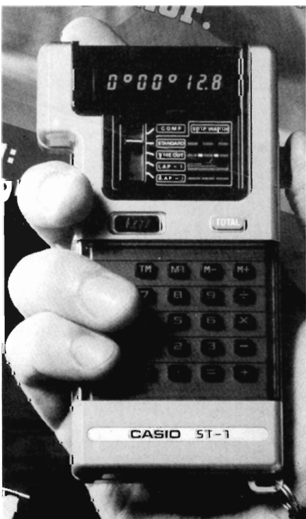
Fig. 1. Elektronisk stopur med indbygget lommeregner. Anvendes til Institutets officielle tidsstudier.
