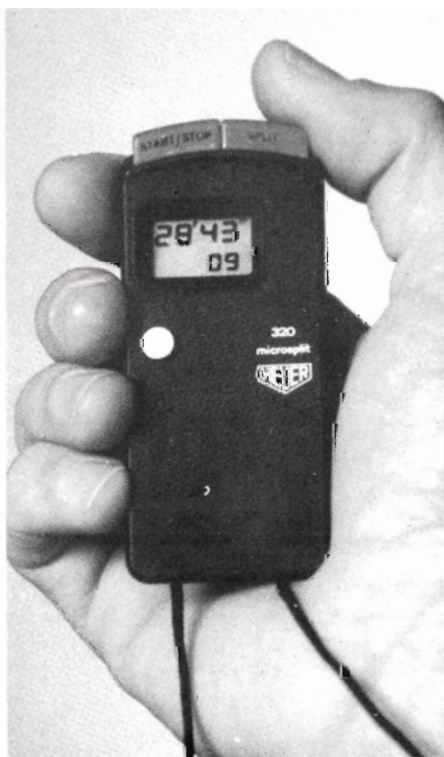
Fig. 2. Elektronisk stopur med flydende krystaller. Anvendes i Niels Hedings løvtræsundersøgelser.
