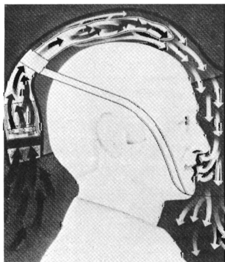
Fig. 7. Arbejdsprincippet i Airstream støvhjelm.
