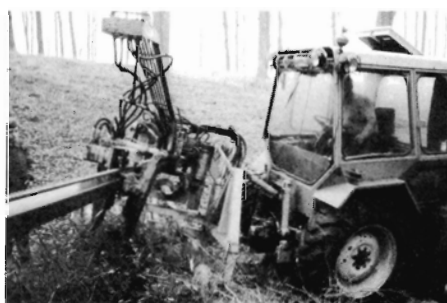
Fig. 1. STRIPPER II på ROWI-TRAC, udstyret med ekstra drejemulighed for bommen.
