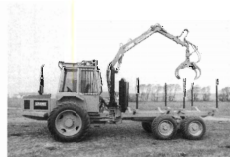
Fig. 14. Udkørselstraktor med midjemonteret kran. Kranen følger forvognens bevægelser, hvilket giver god stabilitet ved tomkørsel, men hårde sidepåvirkninger af kranen i transportstilling.
