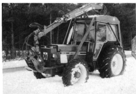
Fig. 10. Tagmontering på skovudrustet landbrugstraktor. Bemærk støttebeslag for kranarm i parkeringsleje.
