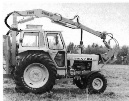
Fig. 11. Kropsmonteret kran. Denne kran-konsol generer for udsynet til siderne og opad.
