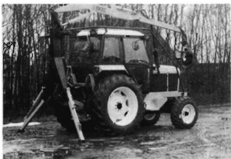
Fig. 12. Liftmonteret kran med hydrauliske støtteben. Kranen bør fastlåses i parkeringsleje.
