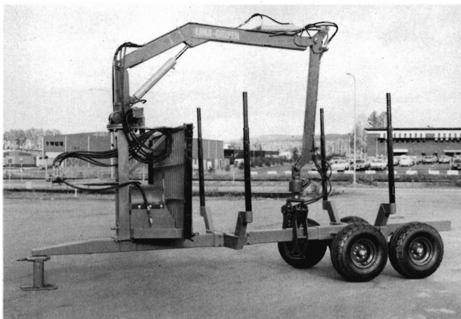
Fig. 3. Giesebo skovkærre med 6 tons lasteevne og 1,5 ton/meter kran.
