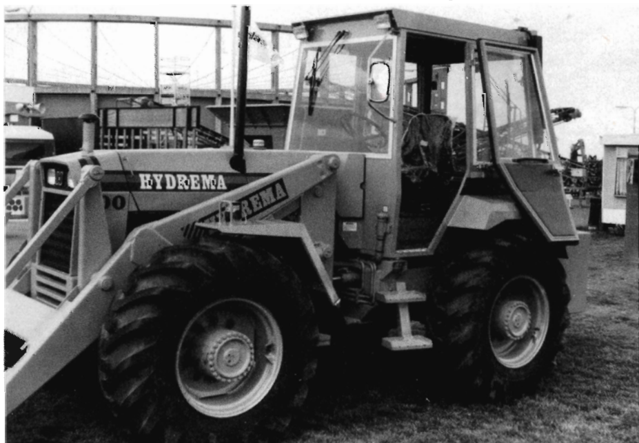
Fig. 7. Hydrema 800 er midjestyret, med firehjulstræk, hydrodynamisk transmission og vendbar førerplads, en tilsyneladende ideel basismaskine til skovbruget.
