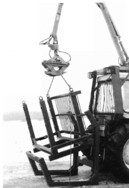
Fig. 6. Rummetergafflen er basisenhed for kurven, som sættes på plads ved brug af kranen.
