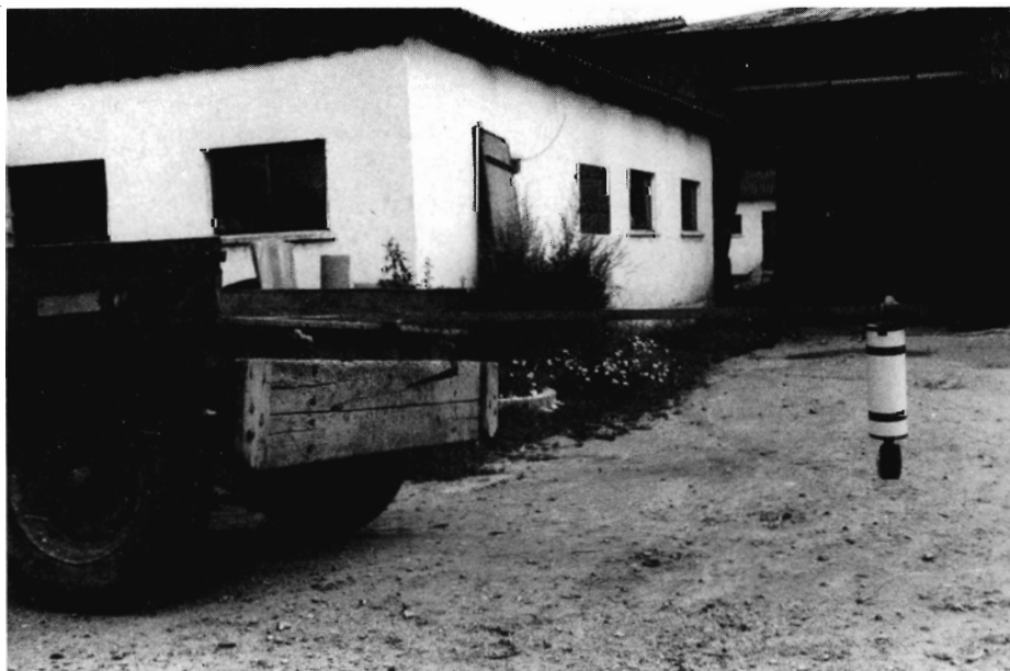
Fig. 1. Afmærkningscylinder med rød/hvid lampe for langt gods. SI-foto.
