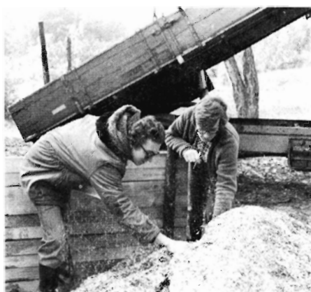
Fig. 3. Den finthuggede fyringsflis betragtes. Det konstateres, at temperaturen i flisbunken ikke er særlig høj, selv om flisen undtagelsesvis er hugget af affaldstræ fra nyskovning.
