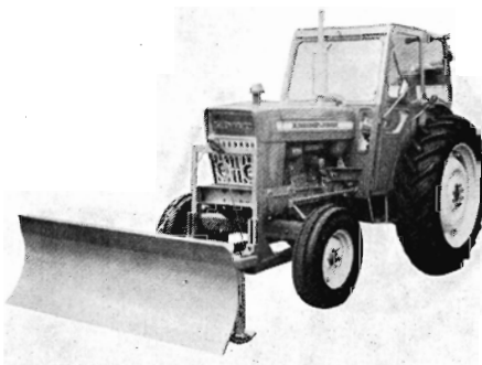
Fig. 2. Dozerblad monteret på jernramme under traktoren. Redskabet er forsynet med slæbesko (Vejma Bulldozer).
