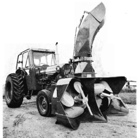
Fig. 4. Dobbelt sneslynge monteret foran på traktoren. Under traktoren skimtes kraftoverføringsakslen. På siden bemærkes det hydrauliske system til drejning og vipning af udkastetrugten (RO-WI SL 2).
