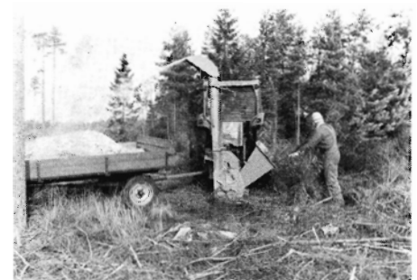
Fig. 2. Affaldstræ hugges til flis på renafdrift. Som det fremgår af billedet, er udstyret ganske enkelt.
