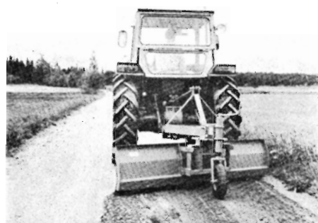
Fig. 1. Bagskraber monteret med støttehjul, der kan indstilles i højden (Vreten TH 225).
