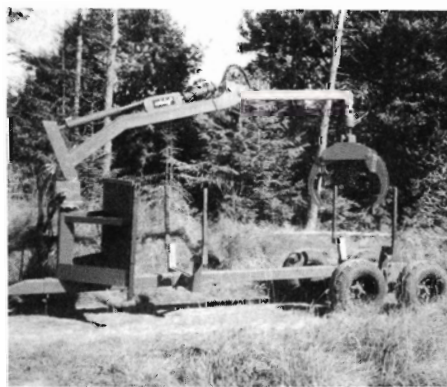
Fig. 5. Molgjer 8 t skovvogn monteret med Scan Chief kran. Vognen fås også som 5 t enakslet kærre.
