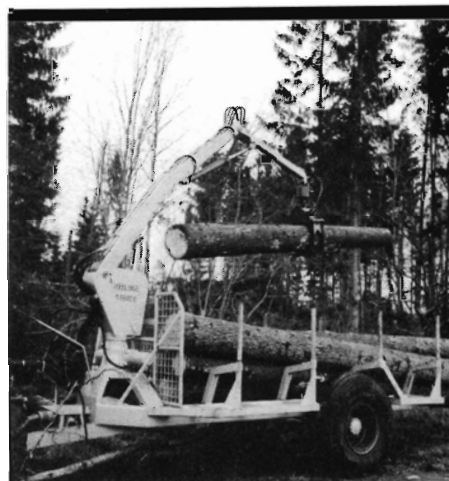
Fig. 7. Håglingevognen III. 8 t kærre med mekanisk drev på vognen.
