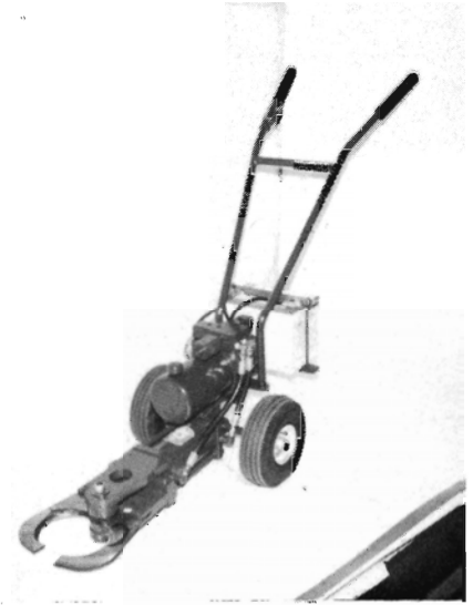
Fig. 3. Hydraulisk juletræsklipper „Termiten”. Maskinen drives af et 12 V batteri.
