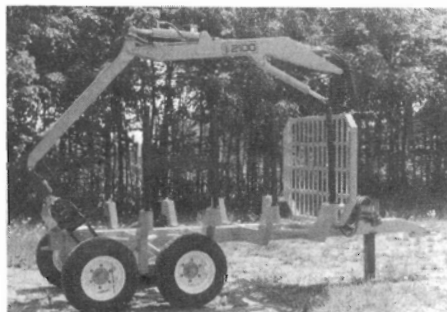
Fig. 4. Rollo 6 t skovvogn monteret m. IIsbo 2100 kran.
