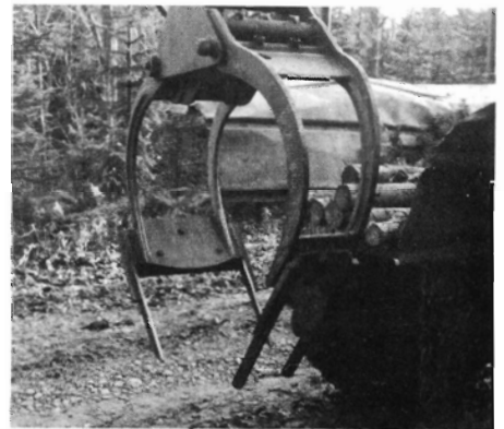
Fig. 5. Krangrab forsynet med forlængere kan læsse op til 8 juletræer ad gangen.
