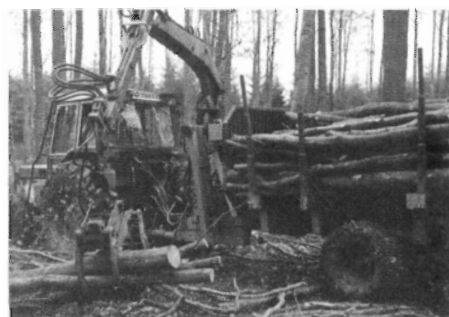
Fig. 6. P.V. skovvogn. Vognen er forsynet med hydrostatisk drev på forreste hjul i hver bogie.
