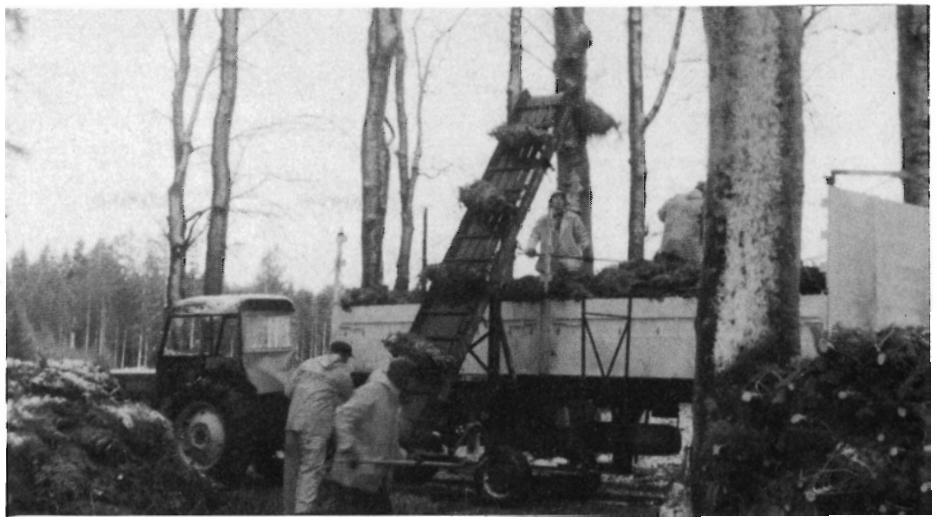
Fig. 3. Læssetransportør med lave sider, så træerne kan ligge på tværs (Rye Nørskov model).
