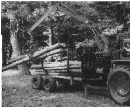
Fig. 2. Skovvogn MH 4000. Vognen fås både som bogievogn og enakslet kærre.
