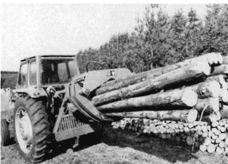
Fig. 5. Loft udkørselstang UK II er en såkaldt fast tang uden drejemuligheder. Tangen er velegnet til udkørsel af 2 m og 3 m træ og kan rumme henholdsvis 1,4 og 2,1 m. Tangen er relativ tung og kræver en fronttung traktor.
