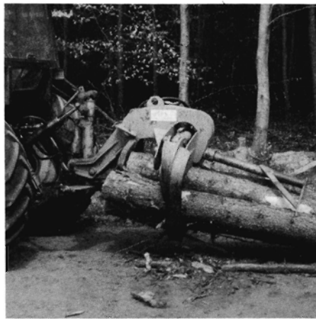
Fig. 3. Loft 1250 udslæbningstang i kombi-version med hydraulisk topstang og låsepæl. Tangen er konstrueret til udslæbning af såvel store som små stammer. Den bagudvendte støttearm bevirker, at tangens bevægelige del fastlåses til læsset, således at trækket foregår i den vandrette drejebolt. Når tangen bruges til udkørsel, fastlåses tangarm og monteringsramme med låsepælen, som betjenes ved hjælp af den hydrauliske topstang.
