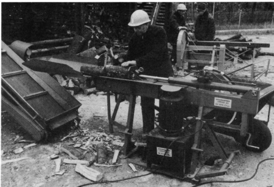
Fig. 6. Kubben vedkløver med slidsk til brændet.
