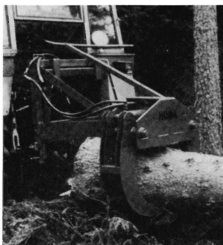
Fig. 8. Huma grabben er en kombitang til transport af mellemstort træ og bunkelagte effekter. Monteringsrammen er dobbelt og tillader mindre bevægelse i det lodrette plan. Grabben er hængslet omkring en lodret bolt og kan drejes ved hjælp af en stang. Hele tangen er meget let og vejer 170 kg.
