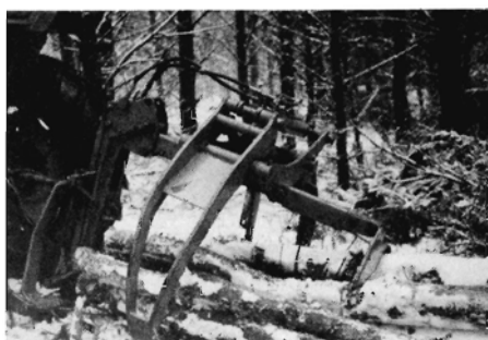
Fig. 7. Kuxmann IV kombitang adskiller sig især fra III'eren ved grabbens udformning, som er et kompromis mellem den brede udkørselstang og den smalle udslebninggrab. Tangarmen kan fjedre i det vandrette plan, ligesom den kan indstilles i en høj og lav position i det lodrette plan. Omstilling mellem udkørsels- og udslebningfunktionen sker ved afmontering af to bolte. Tangen er velegnet til udslebning af såvel store som små stammer samt til udkørsel af bunkelagte effekter.
