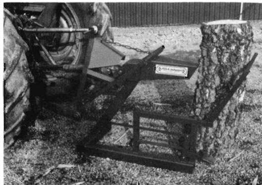
JULA BRÆNDEKLØVER for montering i en traktors 3-punkt ophæng og drevet af kraftoverføringsakslen. Beregnet for 1-meter træ. Bord for kortere træ er ekstraudstyr. Pris frit leveret kr. 3.900,- excl. moms.
