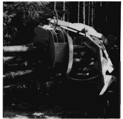
Fig. 4. Loft prototype er en kombitang til alle effektstørrelser bortset fra store løvtrækævler. Tangen omstilles fra udslæbning til udkørsel ved løftehøjden. På billedet er tangen i udkørselsposition. Kæden, der går fra kæbe til kæbe via et drejehjul, sikrer dels lavt træk under udslæbning og dels drejning af den tomme grab via kabel til førerhuset. På tangens traktorside anes et spil, der er monteret på tangen.
