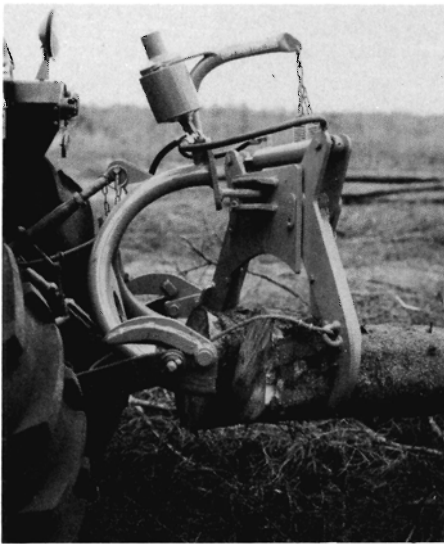
Fig. 2. Loft 550 udslæbningstang er en lille tang til transport af en til to mindre stammer eller kævler. Grabben på billedet åbnes ved tryk fra en olieakkumulator, men kan også leveres til betjening fra et dobbeltvirkende olieudtag. Bemærk wiren, der fra kæberne går omkring to hjul på monteringsrammen og derved sikrer lavt træk.
