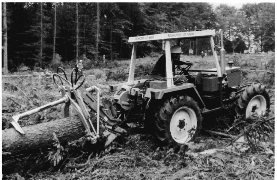
Fig. 6. Kuxmann III udslæbningstang er en kraftig tang med stor klemmekraft. Tangens og specielt grabbens opbygning med et fælles drejeled og gribekløer, der hydraulisk presses indad, når tangen lukkes, gør den velegnet til udslæbning af stort træ. Tangen er på billedet suppleret med et hydraulisk, topstangsmonteret spil.
