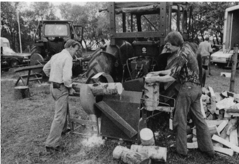
Fig. 8. Horsma kombinerede brændemaskine med vippeladssav og skruekløver.
