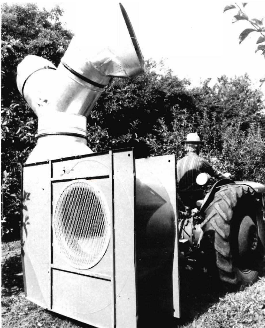
Fig. 4. „Klimaparaply“ (type HB mobil) til frostbeskyttelse.
