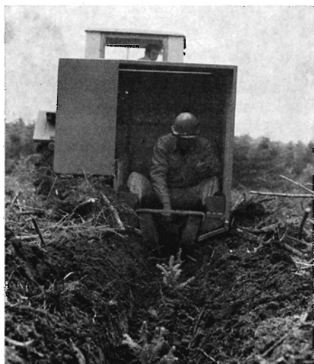
Fig. 2. Hedeselskabets plantningssystem set bagfra og i arbejde.
