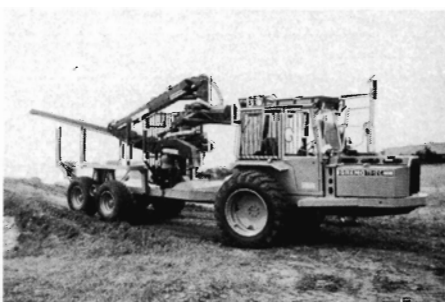
Fig. 11. Gremo SP 30 skovningsmaskine fremtrækker, afkvister og afkorter hele træer. Kan tillige bruges som udkørselstraktor. Optimal træstørrelse 0,5-1,0 m 3 .
