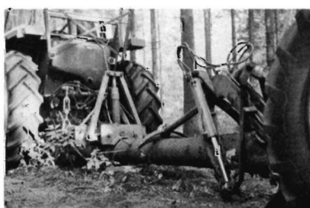
Fig. 10. Trend afkvistningssystem bestående af to traktorer, én med kvisteaggregat og én med hydraulisk tang. Afkvistningen foregår ved, at traktorerne kører fra hinanden. Anvendes bedst på jævnt terræn. Optimal træstørrelse fra 0,5-1,0 m 3 .
