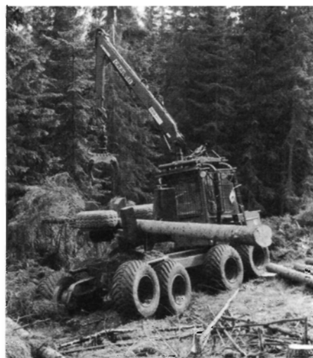
Fig. 9. Bruunett gummihjulsprocessor fremtrækker, afkvister og afkorter hele træer. Maskinen er ikke velegnet til uafkortet tømmer. Optimal træstørrelse omkring 1 m 3 .
