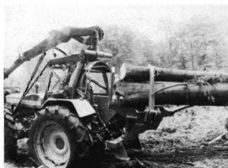
Fig. 6. Klembanke (LOFT) på en kraftig landbrugstraktor kan bruges til fremtrækning og især til udtransport af tømmer.
