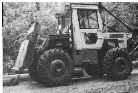
Fig. 4. Traktor med firehjulstræk, kraftigt spil og dozerblad er velegnet til fremtrækning af stort træ på fladefald.
