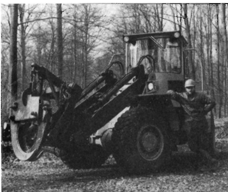
Fig. 2. Gummihjulslæsser med svær hydraulisk tang. Udstyret er velegnet til fremtrækning og udtransport.
