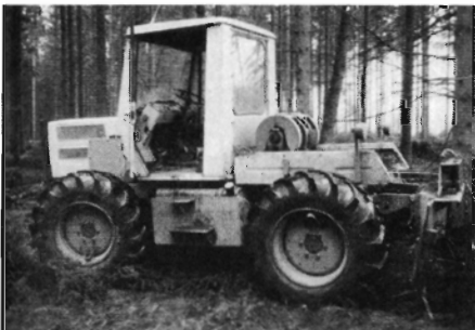
Fig. 3. MB traktor med lige store hjul og 60% af vægten på forakslen i holdende tilstand.
