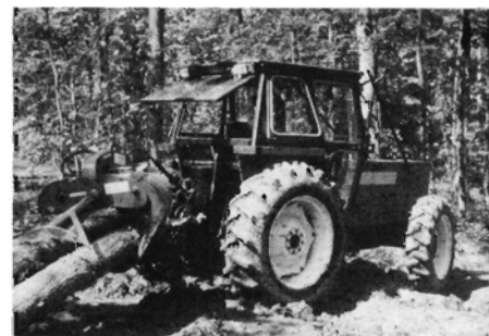
Fig. 1. FIAT 750 DT Forst, firehjulsdrevne traktor med mindre forhjul end baghjul.
