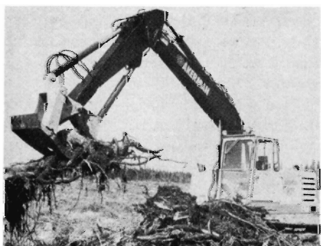
Fig. 7. Grævmaskiner med tømmergraber er velegnede til fremtrækning. Her vises maskinen med et stødrydningsaggregat.
