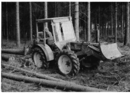
Fig. 2. Holder A 60. Knækstyret traktor med lige store for- og baghjul.
