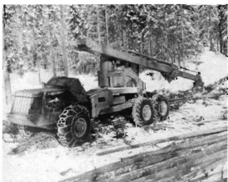
Fig. 8. LOGMA skovningsmaskine fremtrækker, afkvister og evt. afkorter hele træer. Optimal træstørrelse er på ca. 1 m 3 .
