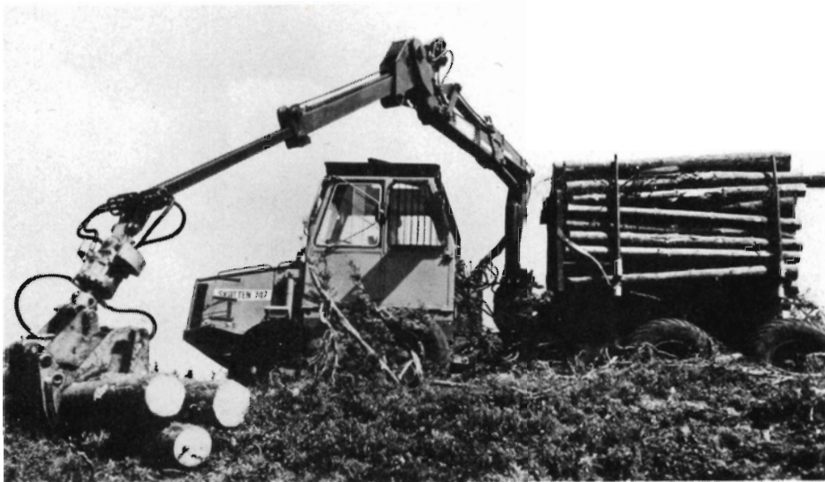
Fig. 2. Cranab 45-85 er en ny krantype med såvel glidebom som hydraulisk udskyder. Det er en hurtig og kompakt kran med max. rækkevidde på 8,5 m.
