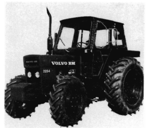
Fig. 1. Volvo 2254 er en firehjulsdrevet traktor i mellemklassen med en motoreffekt på 50 kW
