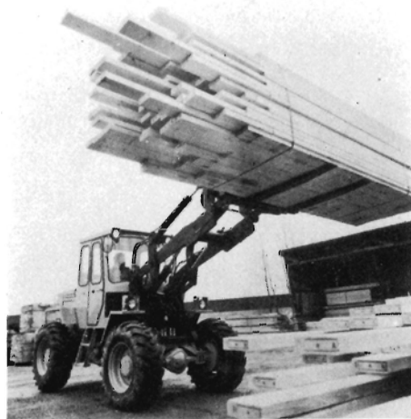
Fig. 3. Læssemaskine model 4200 med en motoreffekt på 43 kW og en lille venderadius på 4,3 m.
