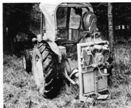
Fig. 2. Liftmonteret kompressor med automatisk slangerulle (Stenhøj).
